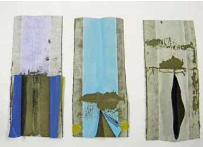
Begrenzte Adhäsionshaftung in der Überlappungszone der Abdichtbänder.
